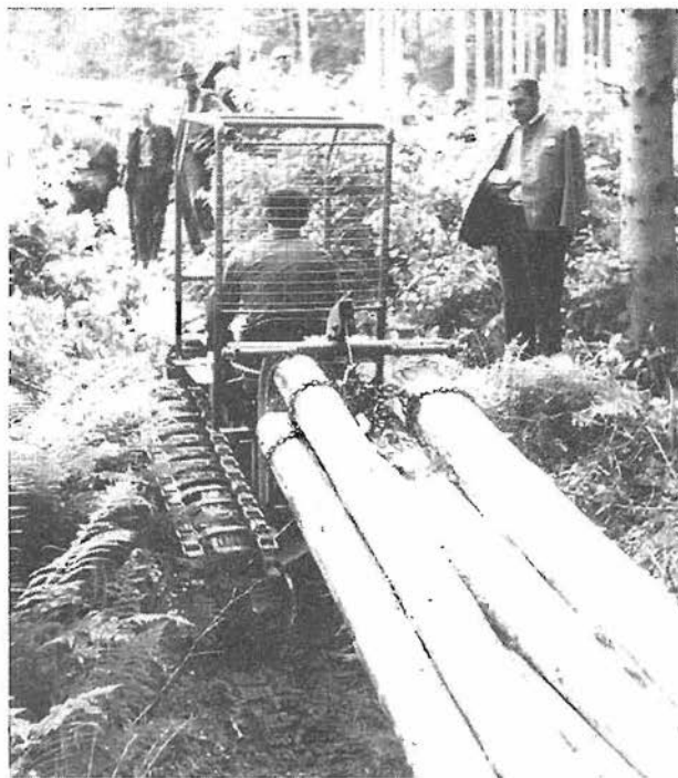
Majhen norveški gosenični traktor »drabant«, 12 KM za spravilo tankega lesa
