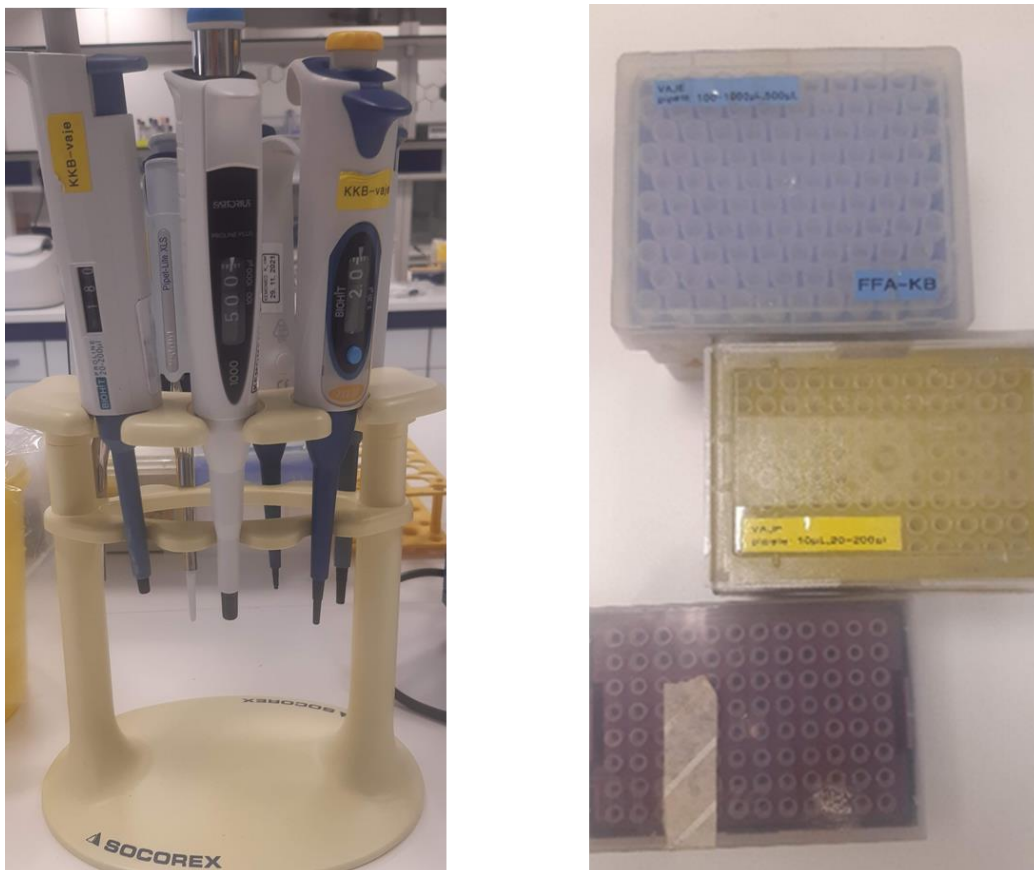
Slika 5. Stojalo za pipete z različnimi volumni in škatle v katerih hranimo nastavke za pipete.
