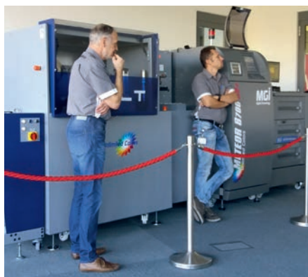
Stroj MGI Meteor 8700 Se+ & iFOIL T tiska lasersko z ločljivostjo 3600 dpi in linijature največ 270 lpi.
