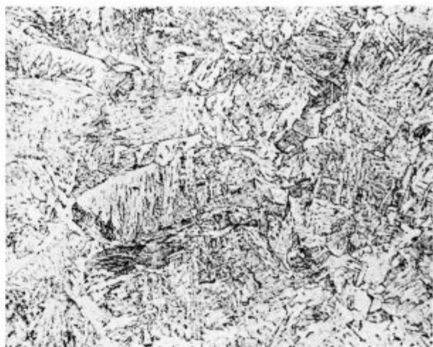
Slika 13 Bainitno feritna struktura prehodne zone; 200 × povečava
