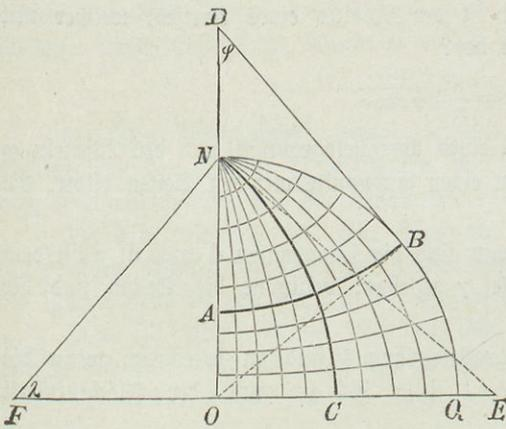
Bei dieser Projektionsart projiziert man die Parallel- und die Meridiankreise aus einem Punkte  $O$  des Äquators auf diejenige Meridianebene, welche mit der durch  $O$  gehenden Berührungsebene der Erdkugel parallel ist. Die Projektionen des Äquators und des durch  $O$  gehenden Meridians sind Strecken, die Projektionen aller übrigen Parallel- und Meridiankreise sind wieder Kreise, und zwar schneiden sich diese unter denselben Winkeln, wie die projizierten Kreise. Die
