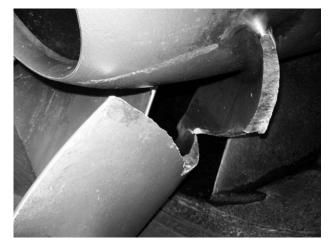
Figure 2: Damaged impeller blade Slika 2: Poškodovana lopatica rotorja
