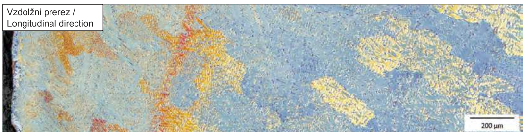
Slika 3. Mikrostruktura kontinuirno lite gredice v vzdolžnem prerezu. Vidni so kot strjevanja in segregacije (jedkano z reagentom Le Pera)
