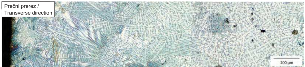
Slika 2. Mikrostruktura kontinuirno lite gredice v prečnem prerezu. Vidni so potek strjevanja, segregacije in osrednja poroznost (jedkano z reagentom Le Pera)
