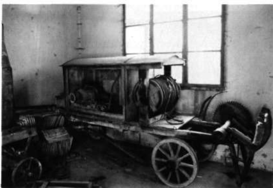
Krožna žaga je bila narejena na vilice, podobno kot v Naklem in Šentvidu. Motor zanjo je priskrbel Jurij Gosar iz Stare Loke, voz pa je izdelal godeški kolar Janez Jenko leta 1932.
