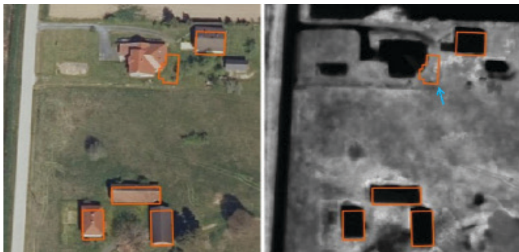
Slika 8: Tlorisi katastra stavb (oranžno), prikazani na DOF v resničnih barvah (levo), ter na podobi NDVI (desno), izdelani na podlagi podobe DOF s kombinacijo rdečega in bližnjerdečega kanala. Z izračunom mediane vrednosti NDVI na območju posameznih tlorisov lahko hitro in učinkovito določimo tlorise, na katerih v resnici ni stavbe. Primer takšnega tlorisa je označen z modro puščico.
