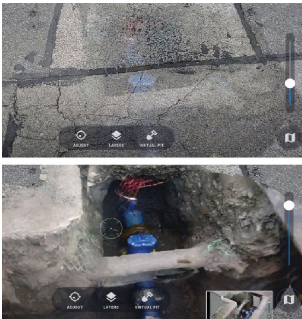
Slika 7: Primer virtualnega izkopa. Zgoraj slika z nastavitvijo nizke prosojnosti vrhnjega sloja. Spodaj slika z nastavitvijo polne prosojnosti vrhnjega sloja. Vir: https://www.vgis.io/ .
