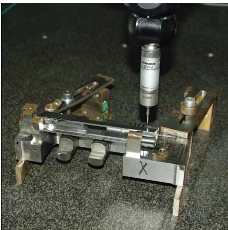
Zaklep (meritev natančnosti izdelave)
