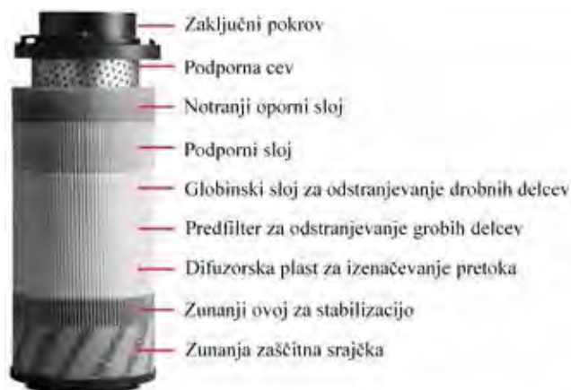
Slika 1 : Značilna zgradba filtrirnega vložka (vir slike: Hydac)
