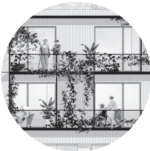
Sl. 1: Fasada bloka s fasadno oblogo iz valovitih vlakno cementnih plošč.
