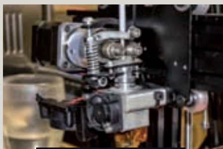
Iztiskalnik (angl. extruder) plastične mase oz. polnila
