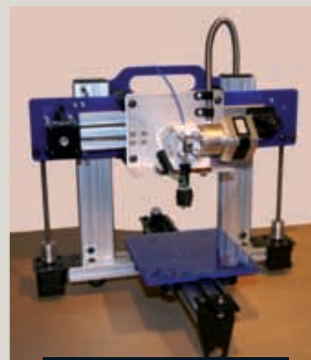
3D tiskalnik s kovinskim in plastičnim ogrodjem, ki ga lahko izdelamo z ročnim orodjem.
