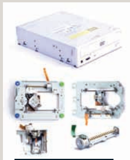
Deli DVD, ki jih lahko uporabimo pri gradnji 3D tiskalnika
