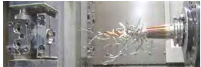
Slika 10 : Prikaz faze strojne obdelave tiskanega kovinskega ohišja
