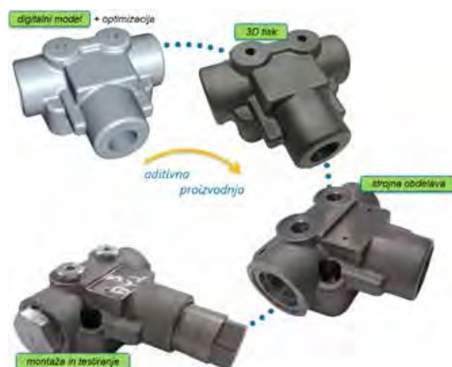
Slika 9 : Prikaz faze aditivne proizvodnje (okvirne dimenzije ventila: 143 x 124 x 55 mm)
