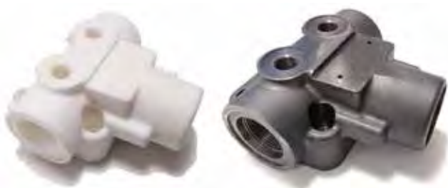
Slika 2 : Ohišja ventilov (tehnologija: levo SLS, desno DMLS, okvirne dimenzije ohišja ventila: 114 x 110 x 50 mm)
