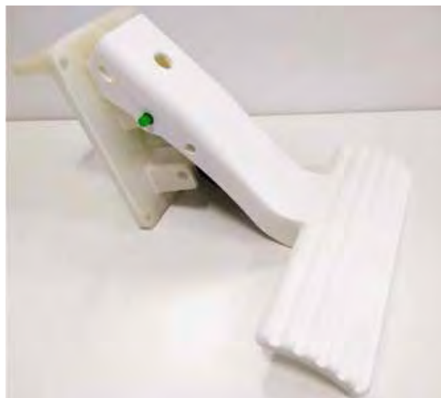
Slika 1 : Zavorna stopalka s podnožjem (tehnologija FDM, okvirne dimenzije zavornega mehanizma: 238 x 282 x 206 mm)
