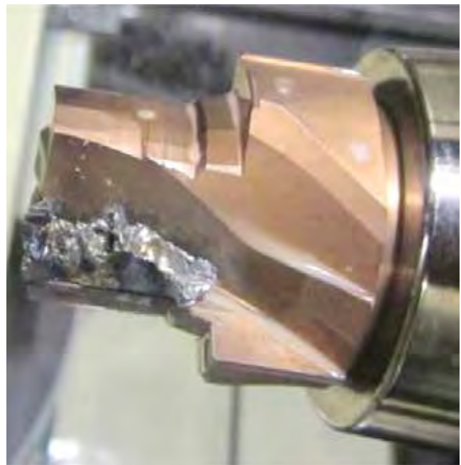
Slika 11 : Lepljenje odrezkov na rezilno orodje
