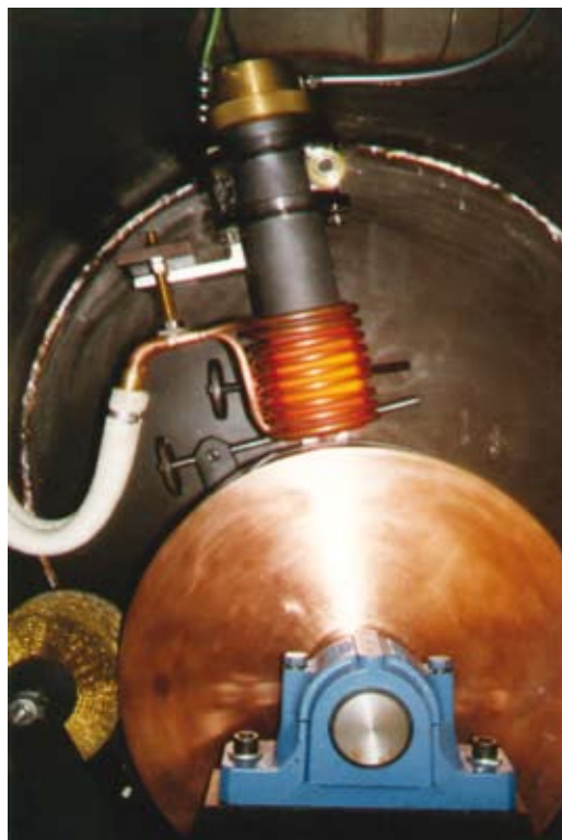
Slika 1. Naprava za izdelavo hitro strjenih trakov na vrtečem se valju
