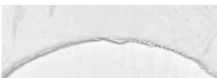
Slika 16: Vidnost plasti pri tehnologiji FDM
