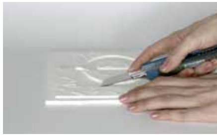
Slika 17: Odstranjevanje podpornih struktur
