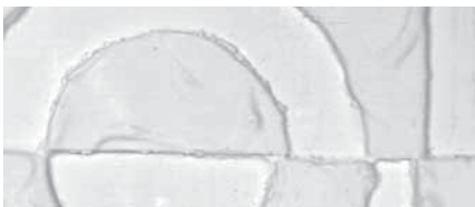
Slika 14: Nazobčanje zaradi težavnega odstranjevanja podpornih struktur
