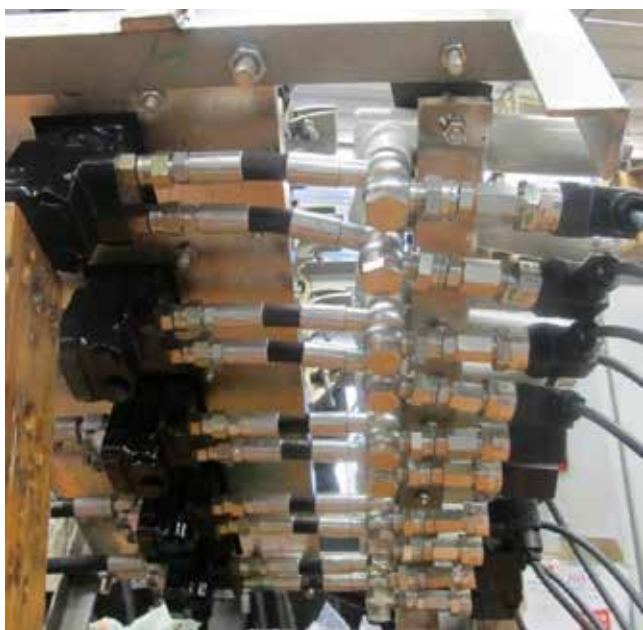
Slika 5 : Merilna mesta in delovni izhodi zavornih ventilov
