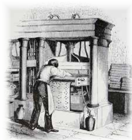
Hidravlična stiskalnica za izdelavo papirnatih robčkov (1845)
