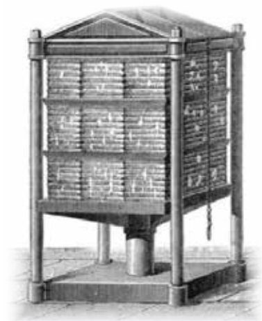
Hidravlična stiskalnica za ločevanje stearinske kisline od oleinske (1900)
