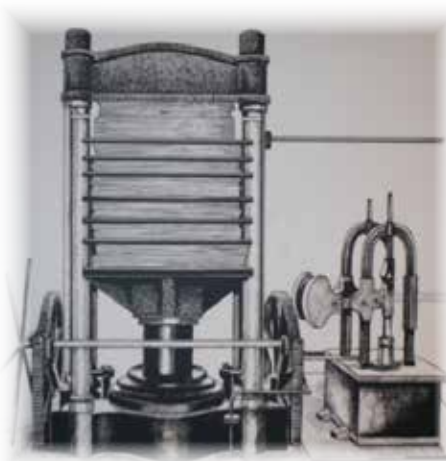
Hidravlična stiskalnica za stiskanje in ravnanje listov v knjigovезnicah
