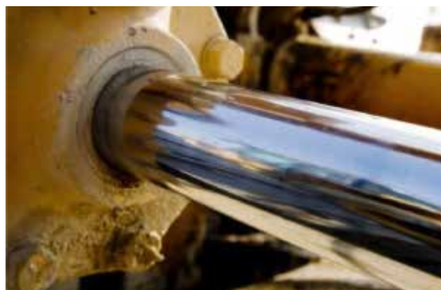
Slika 5 : Poškodba tesnil zaradi pojave »dizel efekta« znotraj HV
