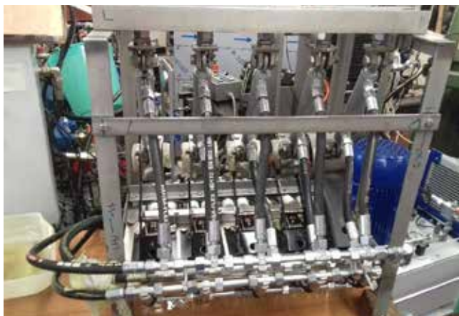
Slika 4 : Preizkuševališče hidravličnih zavornih ventilov
