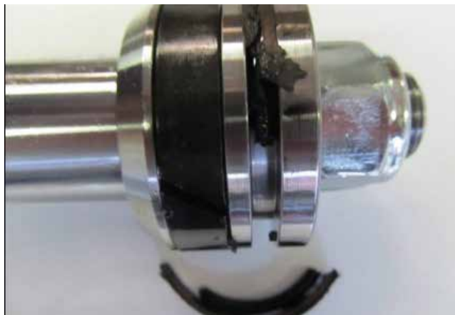
Slika 7 : Primer prekomerno poškodovanega batnega tesnila hidravličnega valja
