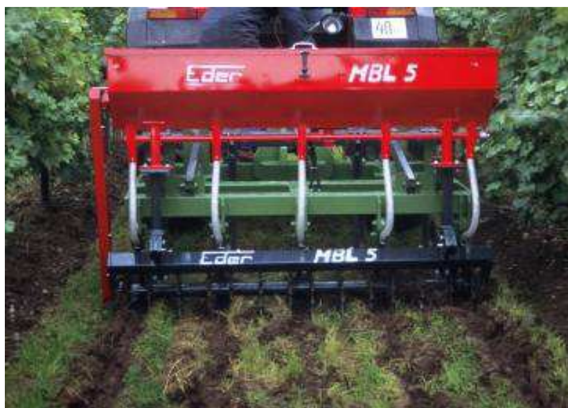
Slika 4: Grobo rahljanje tal oskrbovanih z negovano ledino in dodajanje gnojil z »odlagalcem« za izboljšanje založenosti tal s hranili v drugem horizontu tal (Foto: S. Vršič)
