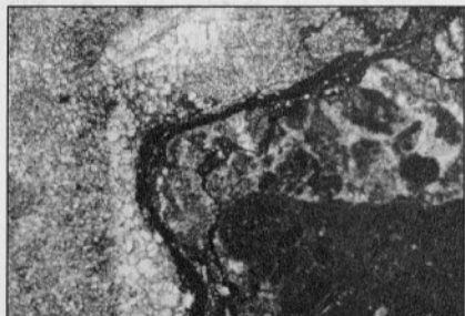
Slika 43. Nazobčan kontakt med apnencem in neenakomerno zrnatim kristalnim dolomitom – nastalo z dolomitizacijo apnenca – nadomeščanjem apnenca z dolomitom. Vz. KG1/173.8, = PL, drs. 5.72 mm.
