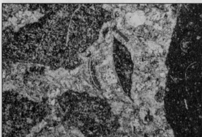
Slika 40. Apnenčeve breče sestavljajo oglati klasti apnencev – deloma rekristaliziranih biomikritov (temni klasti), ki jih veže zrnati kalcitni cement. V njem so tudi svetla zrna kremenca. Vz. KG1/165.2, = PL, drs. 5.72 mm.
