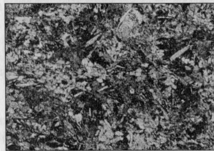
Slika 34. Slika 33 pod navzkrižnimi polarizatorji. Lepo vidna svetla zrna in polja kalcita, ki nadomeščajo kamnino. Vz. KG1/146.8, + PL, drs. 2.86 mm.
