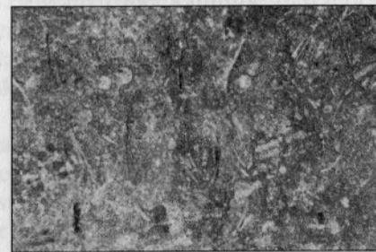
Slika 35. Apnenec – deloma rekristaliziran biomikrit. V delno rekristalizirani, zelo drobnazrnatni osnovi so okrogli preseki s kalcitom nadomeščenih radiolarijev in spikule spongij ter podolgovati preseki tenkolupinskih školjk. Vz. KG1/147.6, = PL, drs. 5.72 mm.
