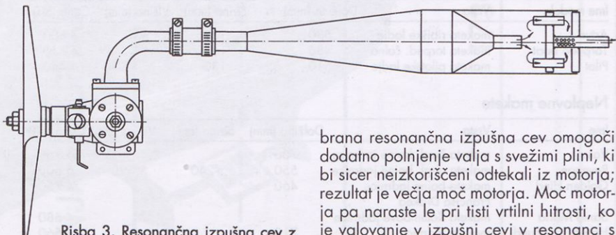
Risba 3. Resonančna izpušna cev z dušilecem hrupa
