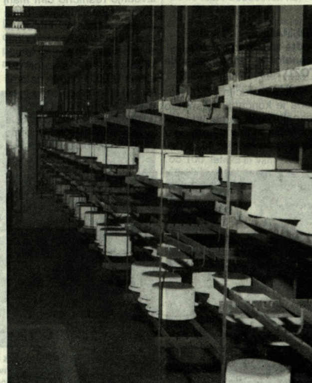
Vhodni transportni trak nove žgalne peči za poltežko in težko posodo.
