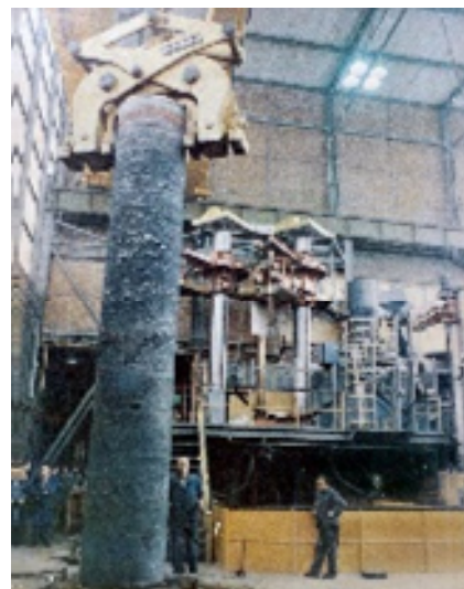
Sl. 5 / Fig. 5: Ingot, 36 ton, dolg 6,24 m, premera 1 m, izdelan v Železarni Ravne leta 1982, pod vodstvom dr. Milana Švajgerja; foto: Inteco; hrani Koroški pokrajinski muzej, Muzej Ravne na Koroškem.
