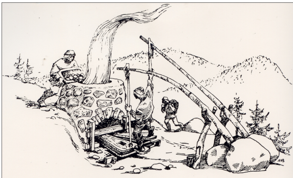
Abb. 4: Roheisengewinnung im Rennofen. Zeichnung von Friedrich Maier – Beck, 1956.
