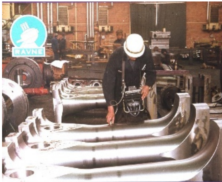
Sl. 6 / Fig. 6: Ultrazvočna kontrola ojnice v mehanični delavnici Železarne Ravne leta, 1970. Koroški pokrajinski muzej, muzej Ravne na Koroškem, inv. št. D 3015.
