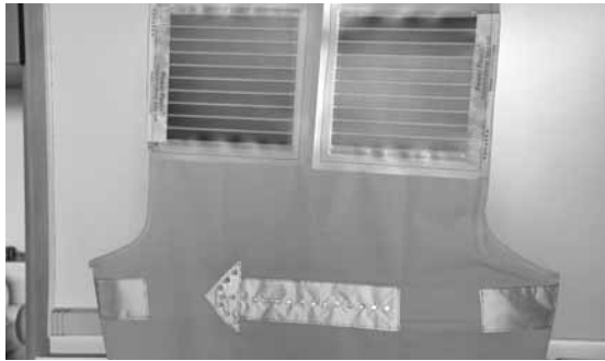
Slika 8: Podrobnosti, fotovoltaične celice – KONAR- KA in svetila LED
