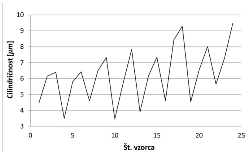
Slika 3. x-kontrolna karta cilindričnosti: prikaz pomanjkljivosti vpenjalne naprave
