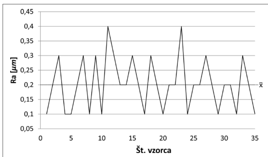
Slika 9. x -kontrolna karta hrapavosti površine Ra: potrditveni test
