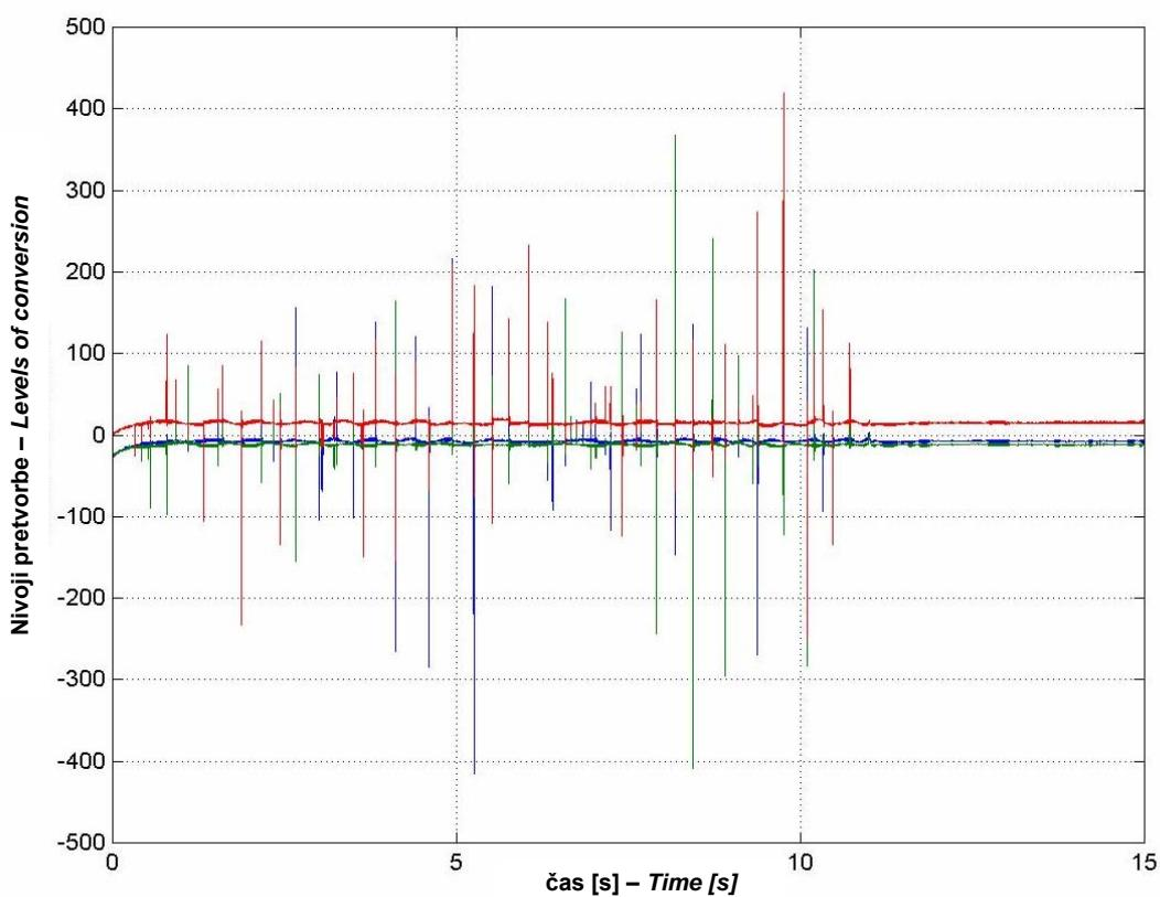
Slika 8. Značilni signal treh merjenih pospeškov v nagibnem žlebu pri 1 % padcu dna.
