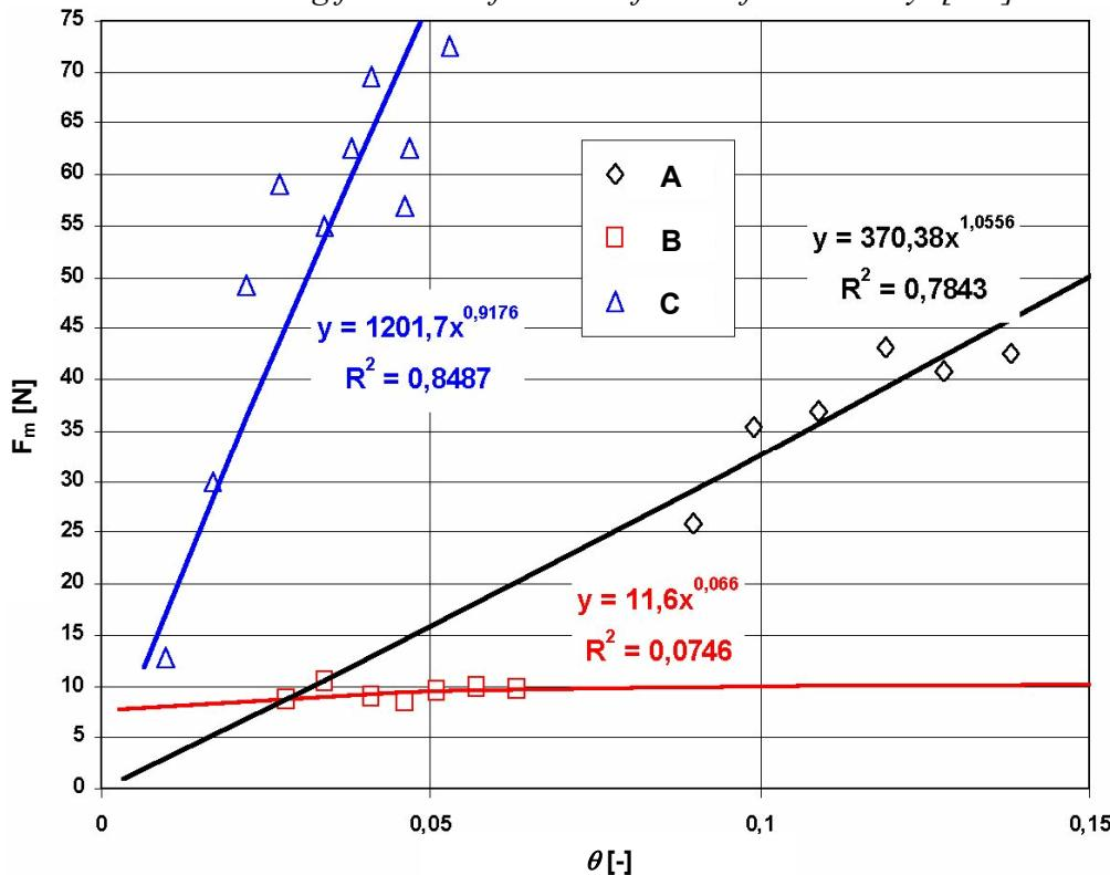
Slika 13. Srednja maksimalna sila  $F_m$  [N] za vsak poskus vseh treh delov (A, B in C) drugega niza laboratorijskih poskusov v nagibnem žlebu v odvisnosti od brezdimenzijske strižne napetosti  $\theta$  [-].
