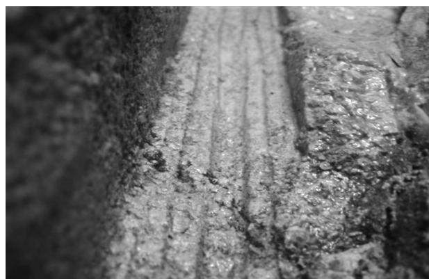
Figure 12: Visible grooves or a cut profile made by the cutting inserts Slika 12: Vidni kanal oziroma profil reza, ki nastaja med rezanjem z rezalnimi ploščicami
