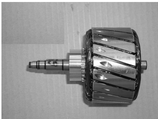
Sl. 1. Rotor z zarezami na površini
