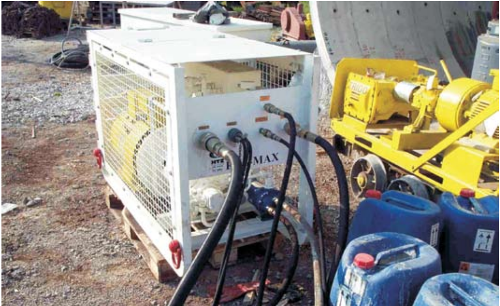
Figure 7. Hydraulic drive unit Slika 7. Pogonski hidravlični agregat
