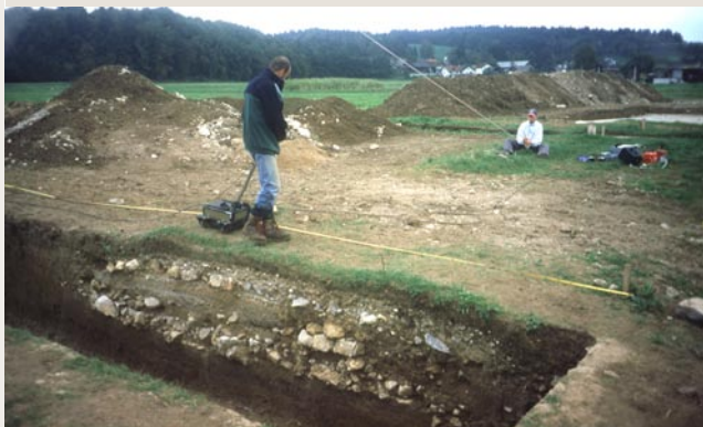
34 Izkopno polje A, sonda 2; Testne meritve s 500 MHz georadarsko anteno s prečnim profilom čez cesto, odkrito pri arheoloških izkopavanjih. Glej tudi georadarski profil na sliki 33.
