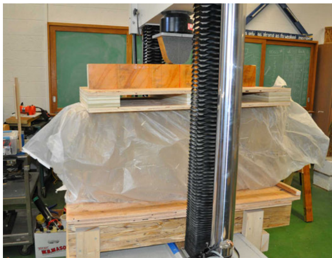
Slika 4: Test tlačne trdnosti.
