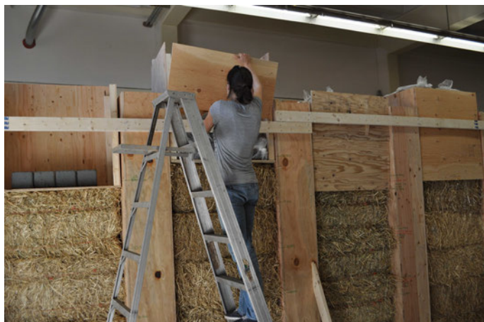
Slika 7: Obteževanje sten z vrečami peska.
