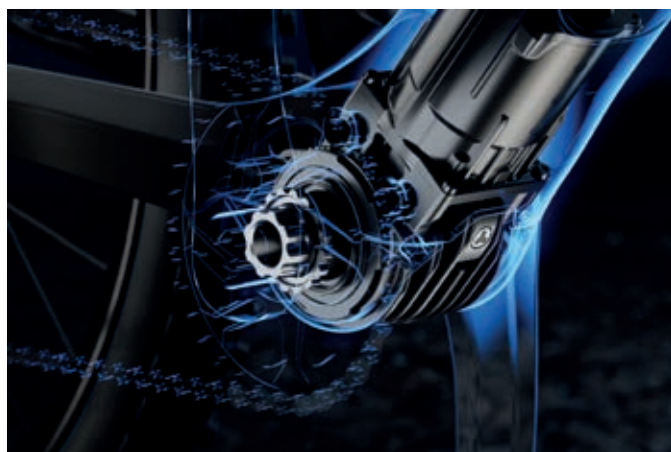
△ Fazua Ride 60 je zelo kompakten motor, ki se skoraj v celoti skriva v cev okvirja.
