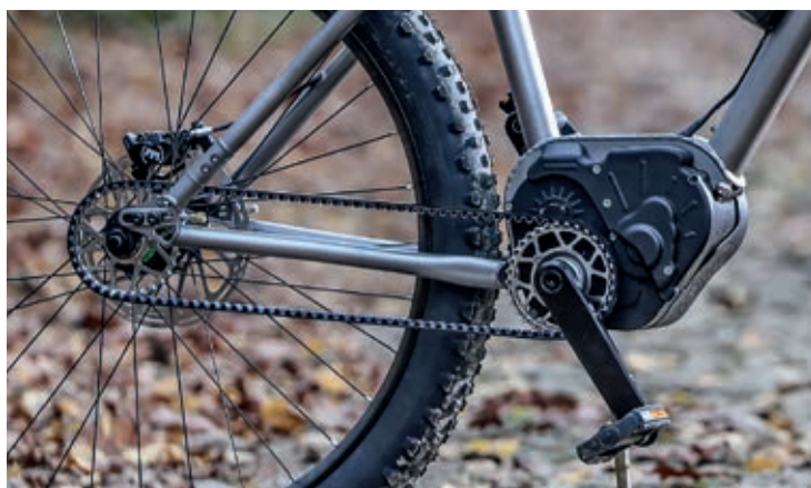
△ Valeo bo najbrž prvi, ki bo ponudil električne motorje s samodejnim menjalnikom. Na sliki je prototip, končni izdelek bo kompaktnější.
