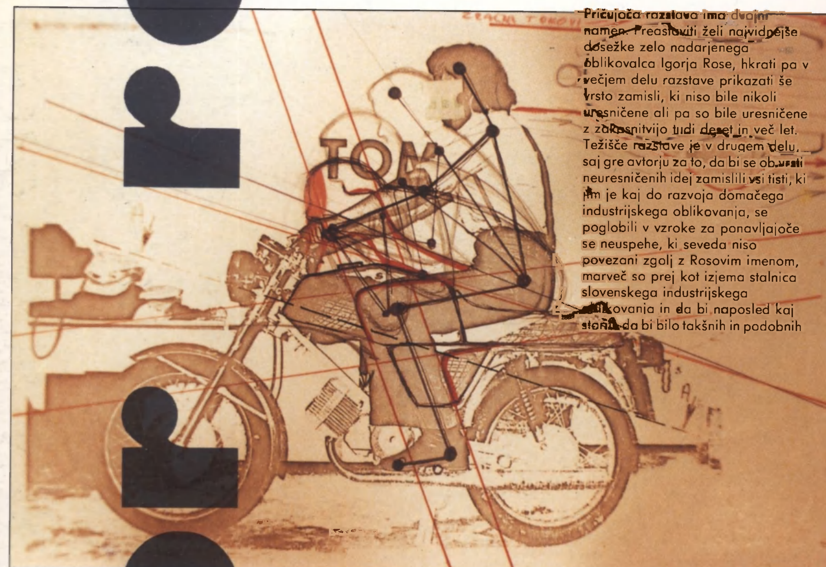
1974 Študija ergonomije sedenja in dotikalnih površin voznika na motociklu T-175
