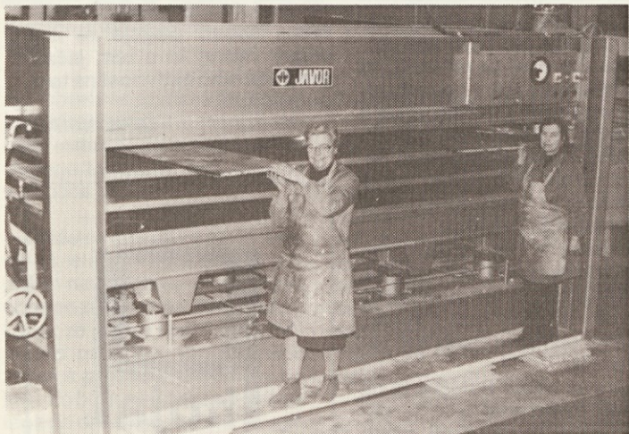
Hidravlična stiskalnica za furniranje (proizvajalec »Javor«, Pivka)
