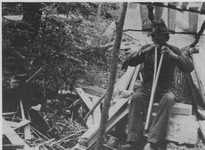
Sl. 4 — Razdvajanje cepanice v skodle, Kočevsko (dela Izidor Zbašnik iz Trave 25, p. Draga pri Kočevju) — Foto: F. Šarf, junij 1975
