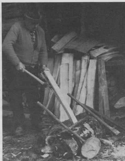
Sl. 2 — Cepljenje skodel v Gozd Martuljku — Foto: Jaka Čop, febr. 1973
