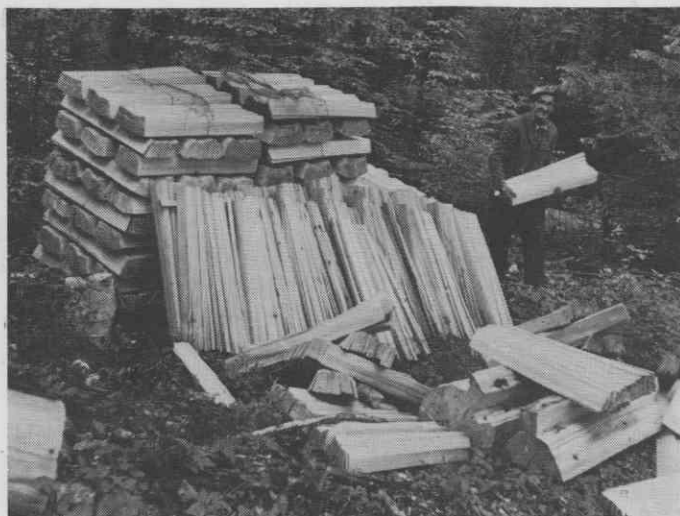
Sl. 5 — Zlaganje skodel. „Šindre“ povezane v „bale“, Kočevsko. Foto F. Šarf, junij 1975.
