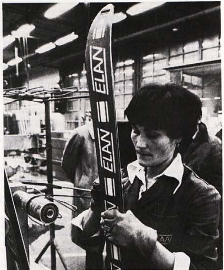
Iz proizvodnje: Merjenje trdote smuči
