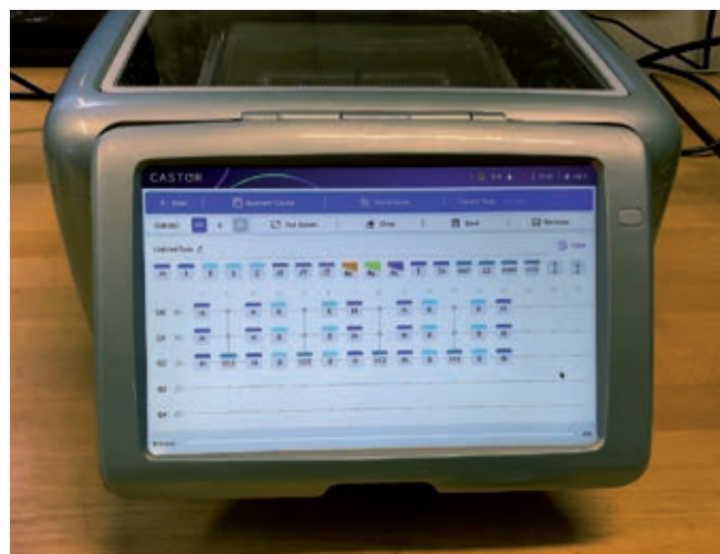
△ Celoto krmilimo s krmilnim računalnikom v obliki tablice z Androidom.
