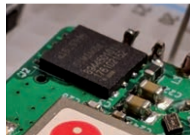
△ Čip MFF2 z eSIM. Slika: Jean-Luc Aufranc (CNXSoft)
