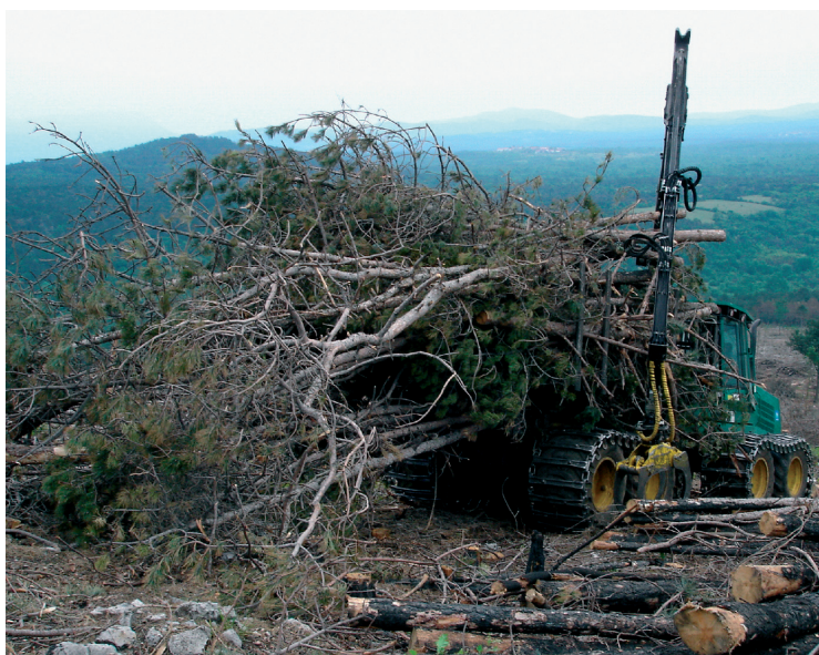
Slika 7: Zgibni polprikoličar Timberjack 1410 naložen s sečnimi ostanki in drobnim drevjem namenjenim za energetske rabo, vendar je tovor za tako velik stroj prelahak, manjši stroj pa bi imel v teh okoliščinah premajhne učinke. Nakladanje sečnih ostankov na zgibni polprikoličar je zahteven postopek, ki je pomemben za ekonomiko spravila.
