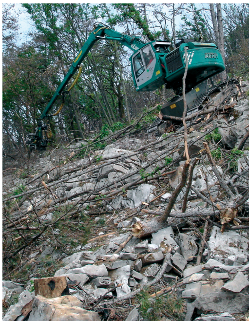
Slika 6: Stroj za sečnjo Konigstiger na pogorelem pobočju. Ta del krasa je pokrit s kamenjem in skalami in ima več strmih, a kratkih pobočij. Na tem delu območja je kamenje zelo krušljivo in se drobi že pri premikanju gosenic po brezpotju.
