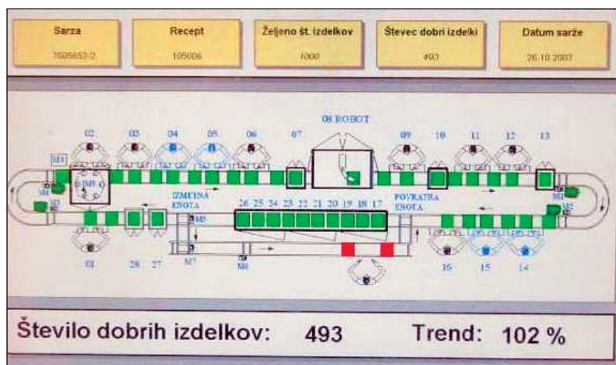
Slika 5. Prikaz montažnih mest in stanja v montaži
