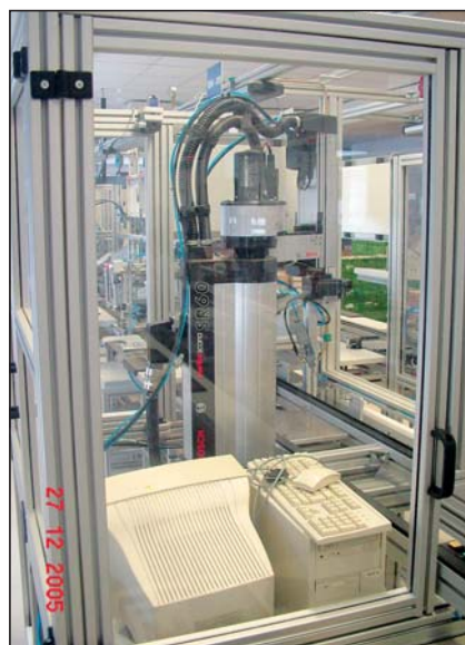
Slika 3. Avtomatizacija mazanja z robotom Bosch
