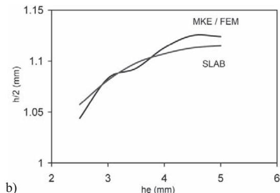
Sl. 6. Drug primer določitve nevtralne točke in možnosti primerjave nevtralne točke med analitično in metodo MKE (a – vzdolžni premik proti stična torna sila za primer  $h_e=5$  mm, b – primerjava lege nevtralne točke proti vstopna debelina)
