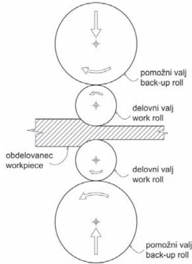
Sl. 1. Sistem štirivaljnega opornega valjanja
