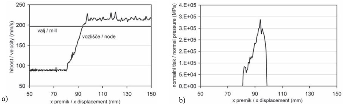
Sl. 5. Določitev nevtralne točke na podlagi metode MKE, na oba načina: z analizo hitrosti in pravokotnega tlaka stika. (a – vzdolžni premik proti hitrost vozlišča za primer  $h_e = 5$  mm, b – vzdolžni premik proti pravokotni tlak za primer  $h_e = 5$  mm)
