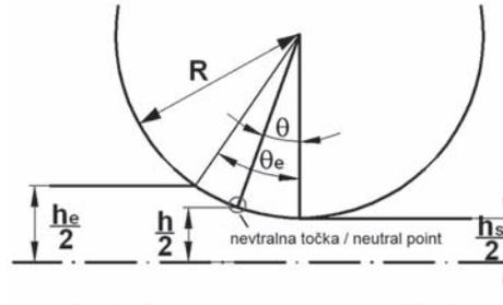
Sl. 4. Parametri za metodo SLAB
