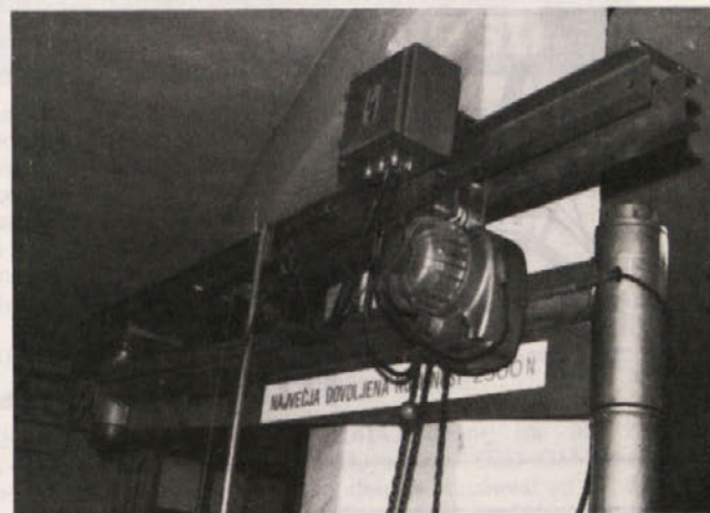
Naprava za dviganje bremen, nosilnost 250 kg.
