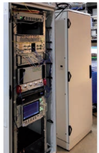
► Kvantni računalnik Univerze v Innsbrucku gre v dve standardni strežniški omari.
