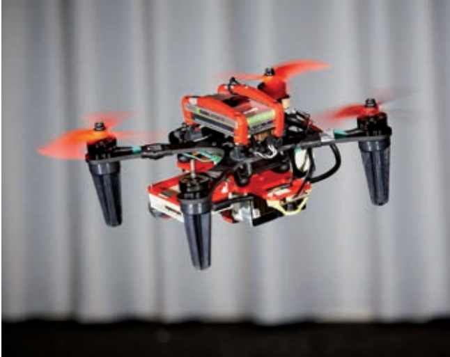
△ Zasilna stabilizacija kvadrokopterja z okvarjenim rotorjem ob pomoči videokamere na krovu.
