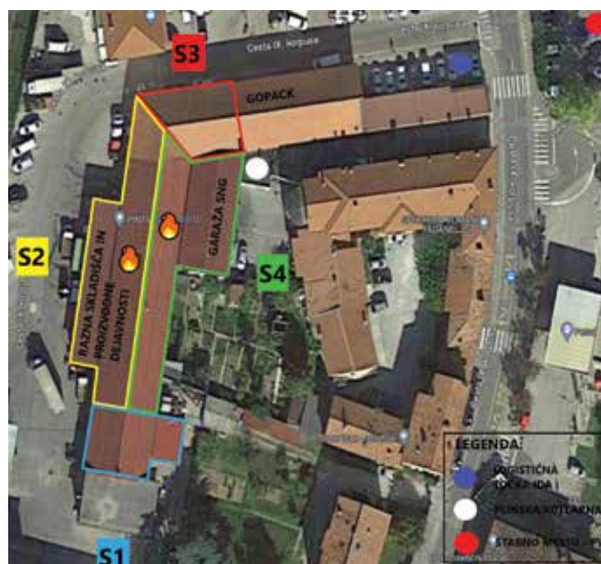
Slika 2: Mikrolokacija območja in sektorizacija objekta
