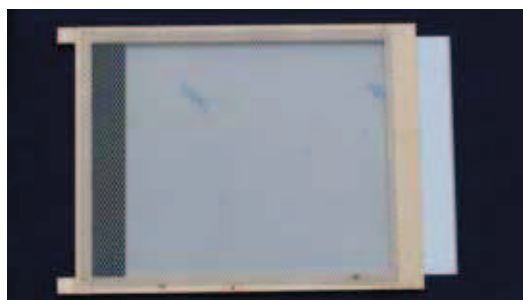
Slika 1: Testni vložek novih mer in izdelave. Zadnja letvica je širša za debelino okenca in za spodnjo debelino zaporne letvice. Je tudi 1 mm tanjša kot pri klasičnem vložku. Testna plošča je iz nerjavečega jekla, debela 0,8 mm; njena zgornja ploskev je prelepljena z zaščitno belo folijo.
