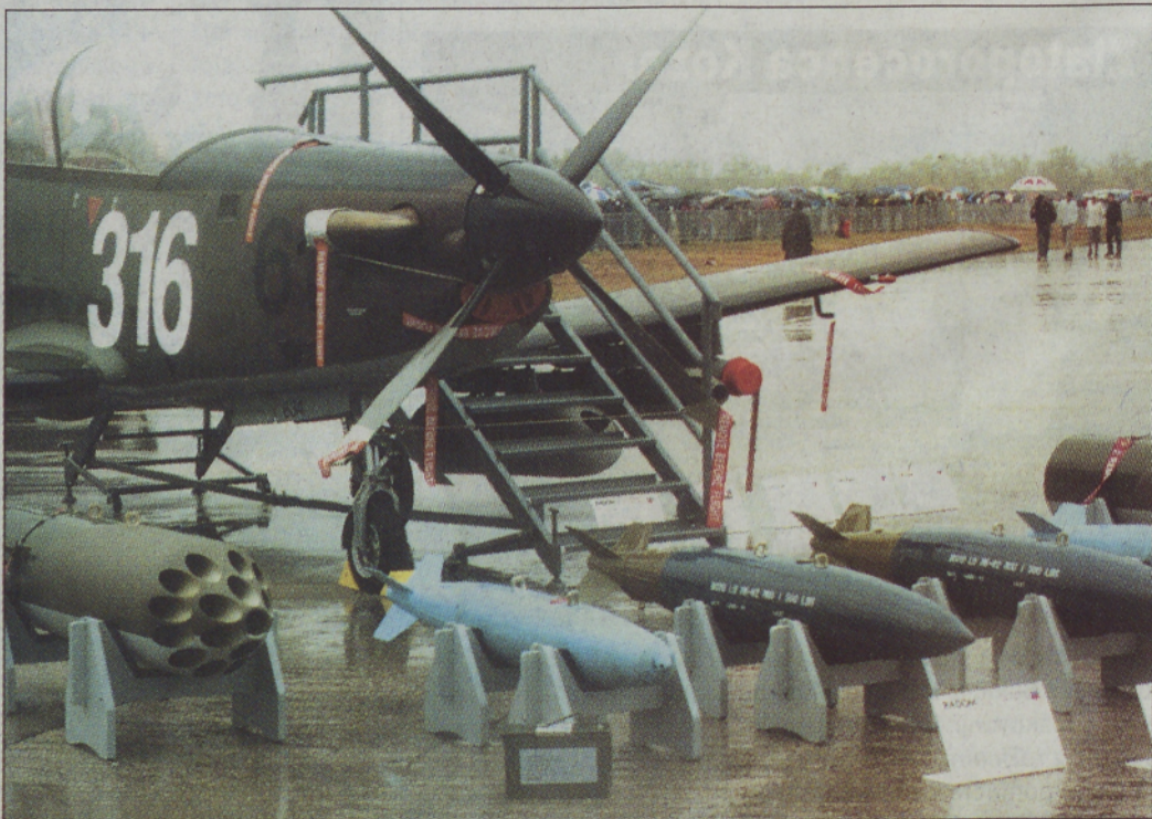
Slovensko vojaško letalstvo se ponaša v kategoriji turbopropelerskih izpopolnjenih šolskih letal z vrhunskim letalom Pilatus PC-9M (PC-9M hudournik), ki ima pod vsakim krilom tri pritrjene točke za nosilce in orožje.
