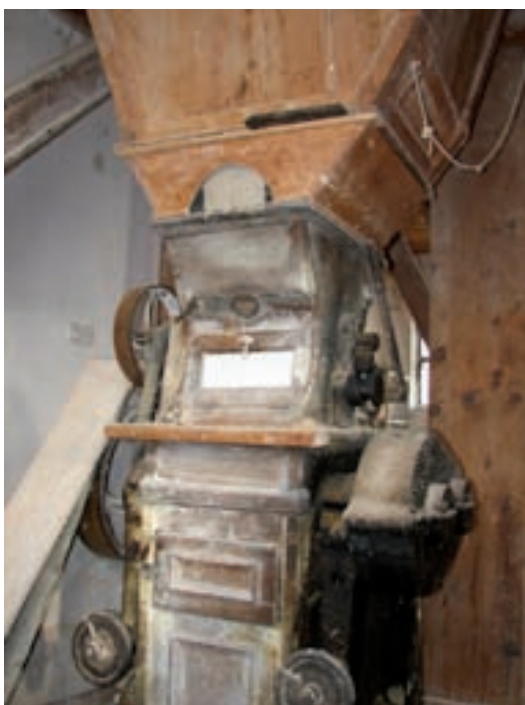
Valjčni mlin v Zorgerjevem mlinu pri Gradu, na katerem so mleli 40 let (na mlinu je letnica 1905) (foto: D. Krpič)
