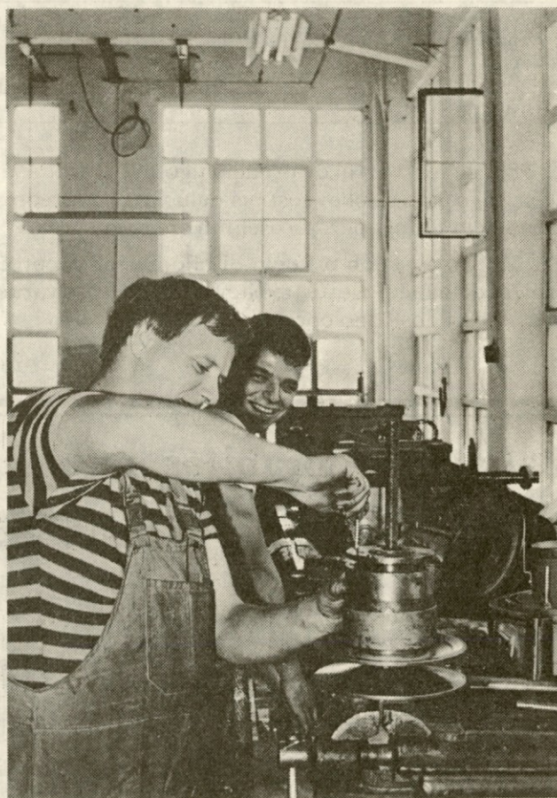
Renato Novak in Vinko Kušar sta popravljala stroj, ki ima bobne iz leta 1903. Potrebno je bilo opraviti tesnenje bobnov — cilindrov za sušenje blaga. To delo se izvršuje enkrat na leto in to v času kolektivnih dopustov.
