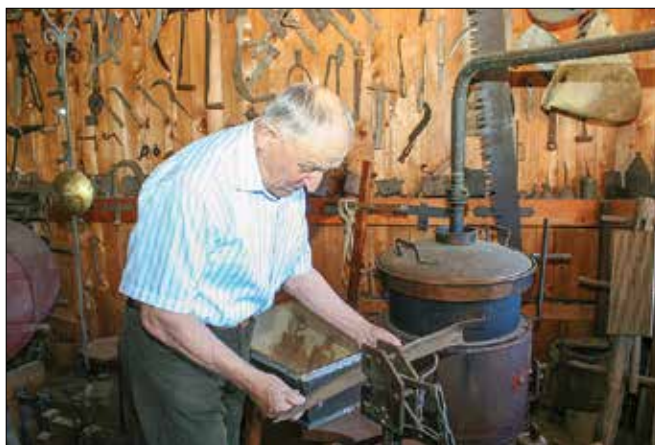
Nazorni prikaz uporabe naprave za najfinejše brušenje kose, v ozadju različno orodje in kotel za žganjekuho.
