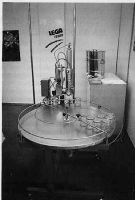
Stroj za polnjenje medu v kozarce za manjša čebelarstva, ki ga izdeluje podjetje Lega.
