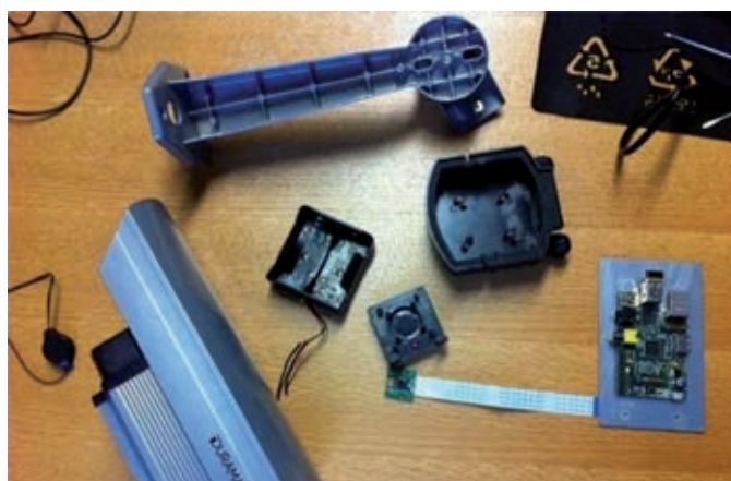
△ Vgradnja kamere z Raspberry Pi v ohišje.
