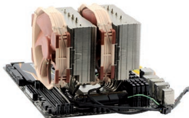
△ Zmogljivi hladilniki za procesorje s kombinacijo masivnih hladilnih rebra in velikih ventilatorjev ponudijo tiho in učinkovito hlajenje. Med bolj znanimi je podjetje Noctua, ki se drži tradicionalne rjave barvne kombinacije.
