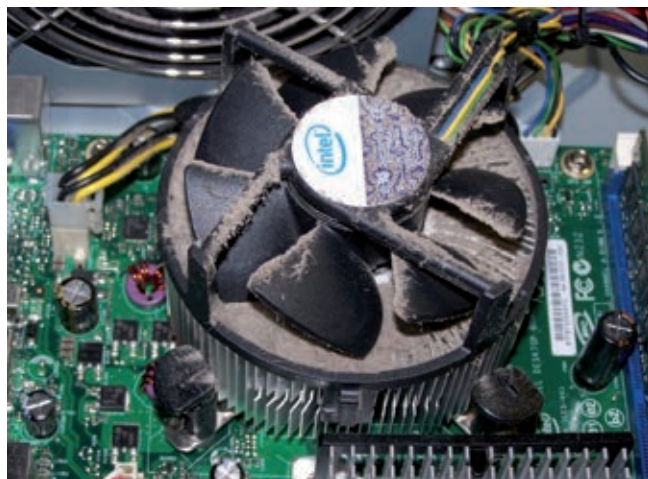
△ Tako stanje redno srečujemo – Intelov hladilnik in ventilator, ki ju loči odeja prahu. Že razstavljanje in čiščenje tega lahko hitro zmanjša glasnost računalnika.
