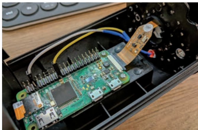
△ Vgrajevanje miniaturne kamere na osnovi Raspberry Pi Zero v ohišje lažne kamere.
