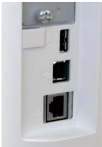
△ Navadni vmesnik USB je seveda na vseh tiskalnikih, zelo koristen pa je klasični omrežni vmesnik.
